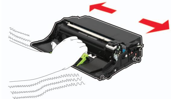
**Upozorenje—potencijalno oštećenje:** Ne izlažite ispisnu jedinicu izravnom svjetlu na duže od 10 minuta. Duže izlaganje svjetlu može uzrokovati probleme s kvalitetom ispisa.
