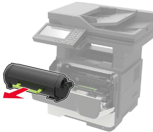
3 Uklonite iskorišćenu jedinicu za izradu slika.
