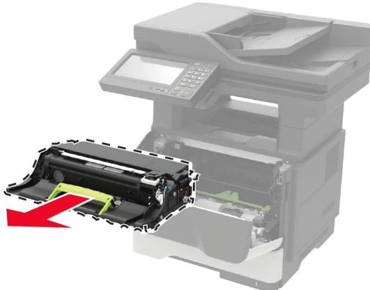
4 Otpakujte novu jedinicu za izradu slika, a zatim je protresite tri puta da biste rasporedili toner.
