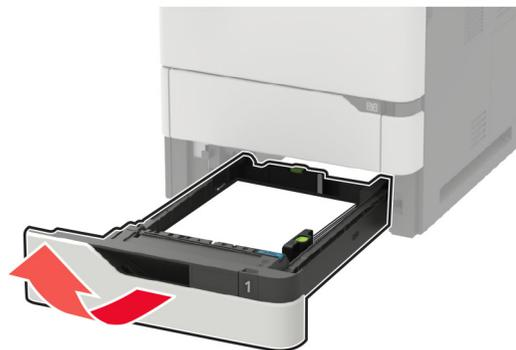
**Warnung—Mögliche Schäden:** Ein Sensor innerhalb des optionalen Fachs wird durch statische Aufladung leicht beschädigt. Berühren Sie einen Metallgegenstand, bevor Sie das verklemmte Papier in dem Fach entfernen.
