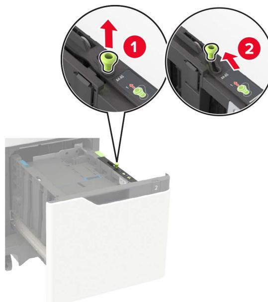
**b** Ako A5 vodilica za duljinu još uvijek pričvršćena, odvojite je. Ako vodilica nije pričvršćena, nastavite do [d. korak na 5. str.](#).
