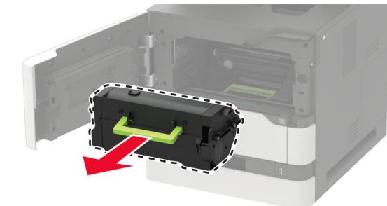
**3** Распакуйте новый тонер-картридж, затем потрясите его, чтобы распределить внутри тонера.
