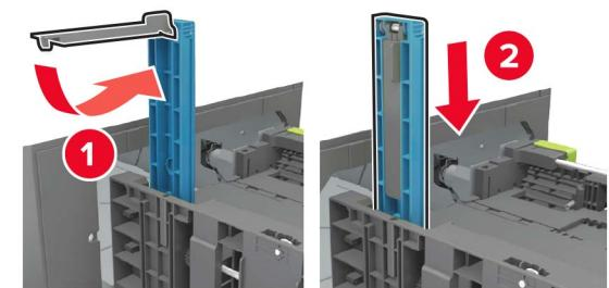
**г** Сожмите фиксаторы направляющей длины и передвиньте направляющую длины бумаги в
