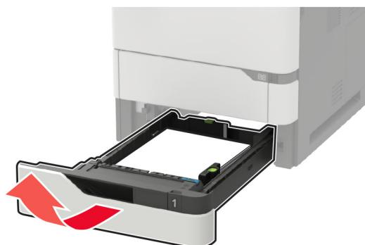
**Výstraha – Riziko poranenia:** Snímač vnútri voliteľného zásobníka sa môže ľahko poškodiť statickou elektrinou. Pred odstránením zaseknutého papiera v zásobníku sa dotknite kovového povrchu.
