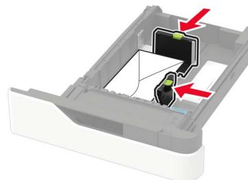
**Upozorenje – potencijalno oštećenje:** Nemojte da koristite koverte sa markicama, spajalicama, prozorima, premazima ili samolepljivim trakama.
