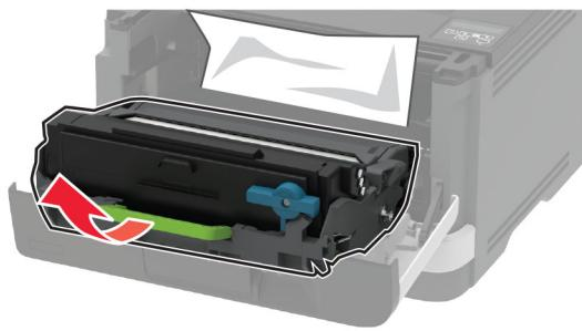
**Upozorenje – potencijalno oštećenje:** Jedinicu za izradu slika nemojte da izlažete direktnom svetlu duže od 10 minuta. Produženo izlaganje svetlu može da uzrokuje probleme sa kvalitetom štampe.
