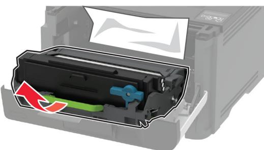
**請當心一潛藏損壞危險性：**成像組件直接曝露在光線下的時間不宜超過 10 分鐘。曝露在光線下太久，會導致列印品質發生問題。
