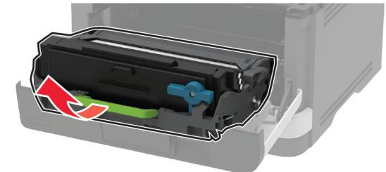
**請當心—潛藏損壞危險性：**成像組件直接曝露在光線下的時間不宜超過 10 分鐘。曝露在光線下太久，會導致列印品質發生問題。
