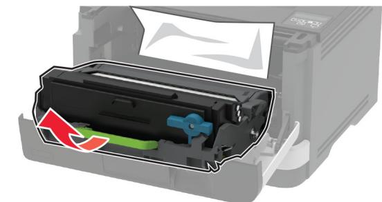
**請當心一潛藏損壞危險性：**成像組件直接曝露在光線下的時間不宜超過 10 分鐘。曝露在光線下太久，會導致列印品質發生問題。
