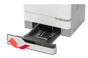
2 Ajuste las guías para que coincidan con el tamaño del papel que va a cargar.
