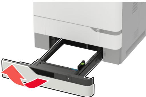
**警告—可能的损坏：**进纸匣选件内部的传感器容易被静电损坏。在移除卡在进纸匣中的纸张之前，请触摸一下金属表面。
