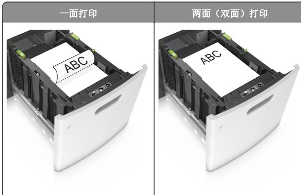
• 确认纸张低于最大纸张加载指示线。
