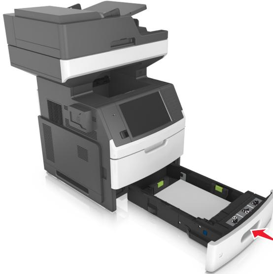
8 從印表機控制面板上的「紙張」功能表，設定紙張尺寸和紙張類型，使其符合載入紙匣組件中的紙張。
