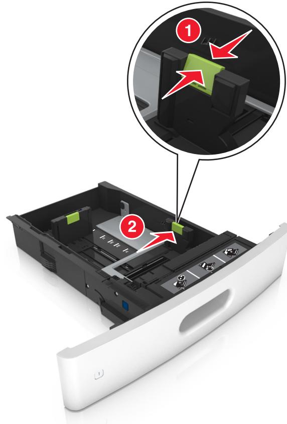
**注意:** 请使用进纸匣底部的纸张尺寸指示器来帮助放置导片。
