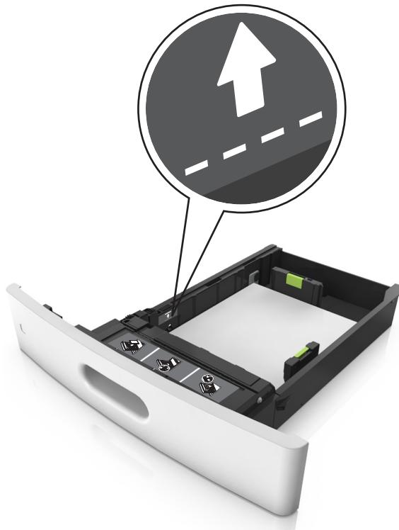
6 对于自定义或 Universal 尺寸纸张，请调整纸张导片到轻微接触纸堆边缘的位置，然后锁定长度导片。
