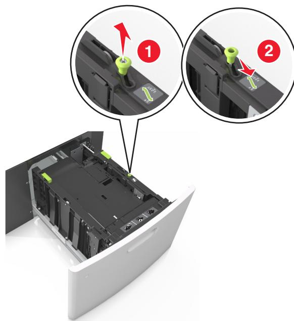
b 捏住長度導引夾，將它滑到 A5 適用的位置，直到它發出喀嚓一聲，卡入定位。
