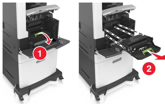
**警告—潛藏損壞危險性：**成像組件直接曝露在光線下的時間不宜超過 10 分鐘。曝露在光線下太久，會導致列印品質發生問題。
