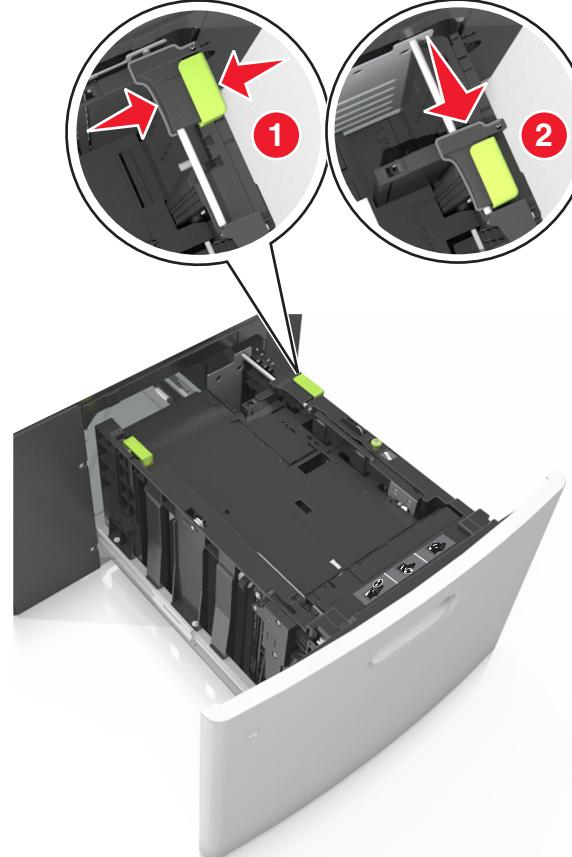
c 從 A5 長度導引夾的夾具中，取出 A5 長度導引夾。
