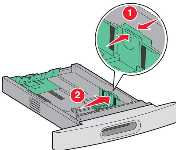
**3** Desbloquee la guía de longitud, presione la lengüeta de la guía de longitud hacia adentro tal como se muestra, y desplace la guía a la posición adecuada según el tamaño del papel que desee cargar.
