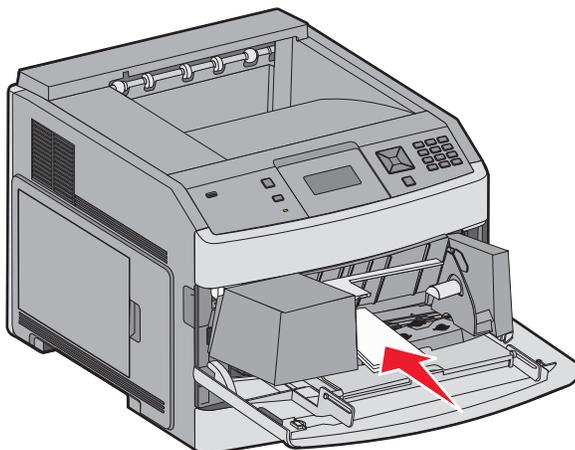
**Nota:** No exceda la altura de pila máxima intentando introducir más papel bajo el limitador de altura de pila.
