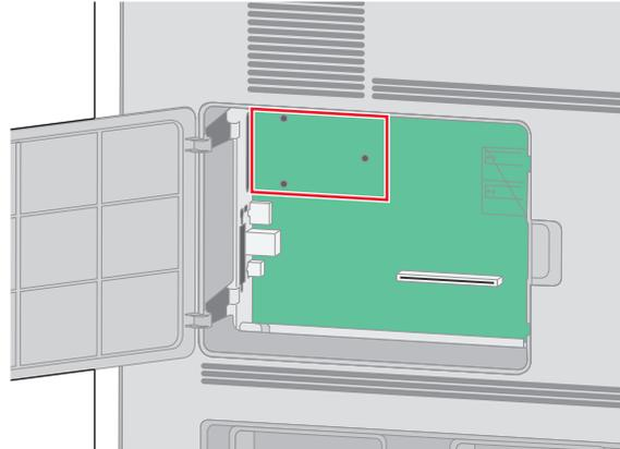
**Nota:** Si hay un ISP opcional instalado, el disco duro de impresora debe instalarse en el ISP.
