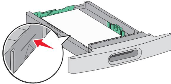
**6** En su caso, ajuste las guías del papel para que toquen ligeramente los laterales de la pila y bloquee la guía de longitud para los tamaños de papel indicados en la bandeja.
