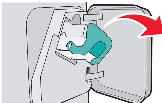
3 Utilice la lengüeta metálica para levantar la protección de grapas y extraiga las grapas sueltas que queden.
