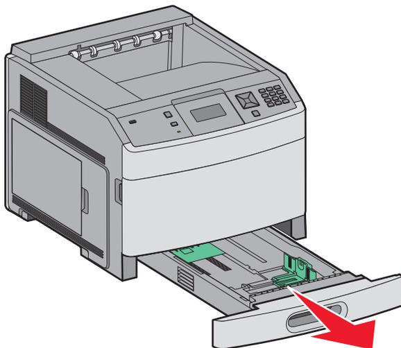
**2** Presione la lengüeta de la guía de anchura hacia dentro, tal como se muestra, y desplace la guía de anchura a la posición adecuada según el tamaño del papel que desee cargar.
