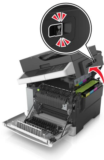
**3** Extraiga el cartucho de t ner levantando las palancas y, a continuaci n, tirando suavemente del kit de imagen.
