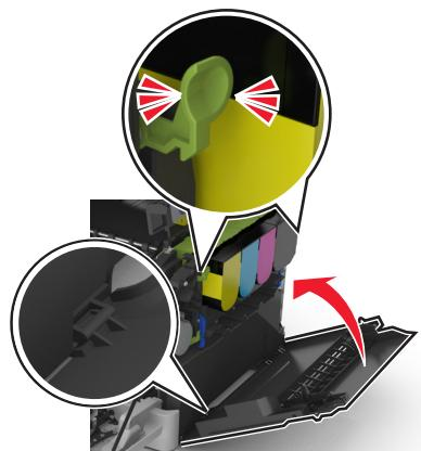
9 Сдвиньте фиксатор лотка на правой панели принтера и осторожно закройте верхнюю дверцу.
