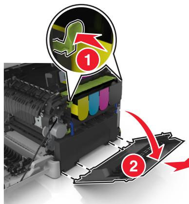
**5** Нажмите на зеленые рычаги с обеих сторон ёмкости для отработанного тонера и извлеките ее.
