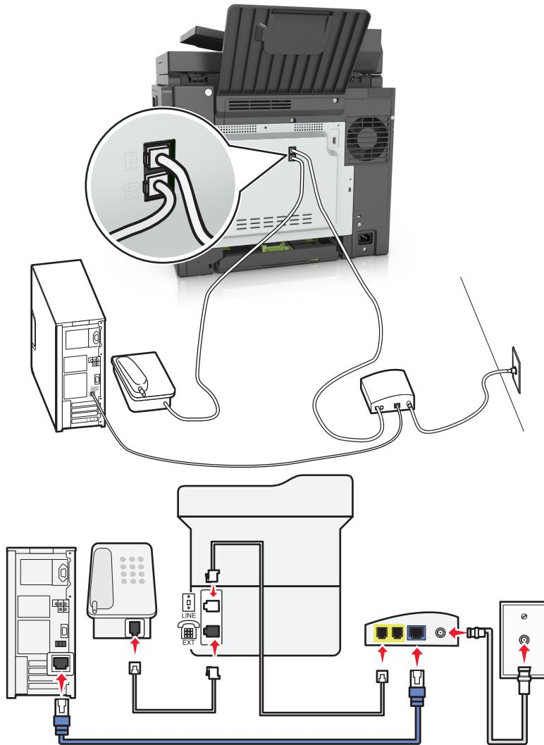
1 Подсоедините один разъем телефонного кабеля, прилагаемого к принтеру, к порту принтера.
