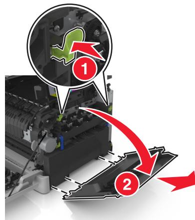
5 Нажмите на зеленые рычаги с обеих сторон ёмкости для отработанного тонера и извлеките ее.
