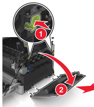
5 Нажмите на зеленые рычаги с обеих сторон ёмкости для отработанного тонера и извлеките ее.
