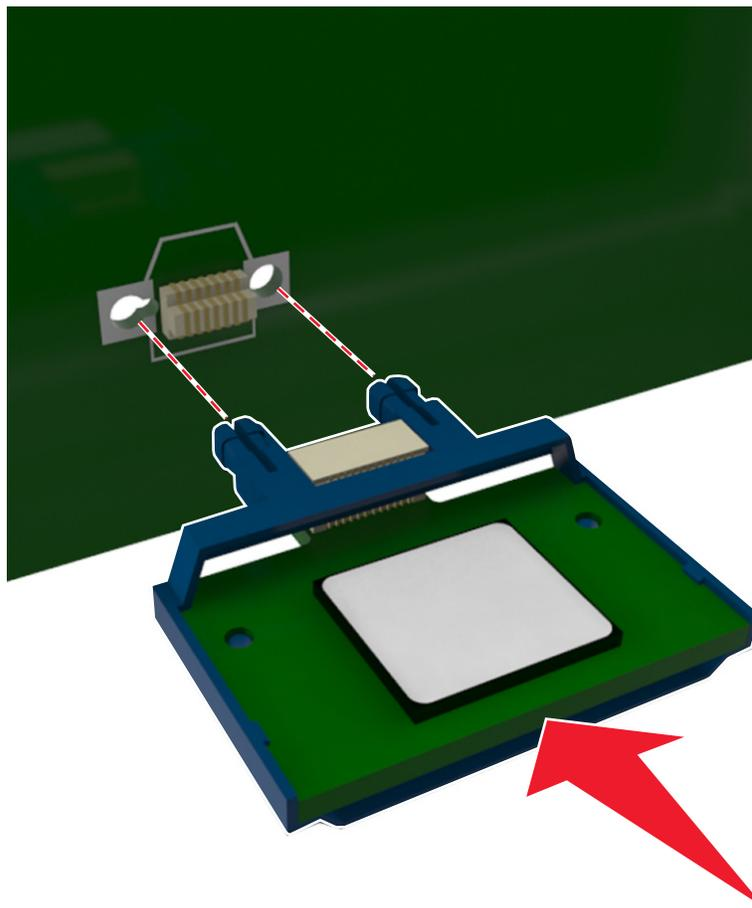
**Attenzione - Possibili danni:** L'installazione errata della scheda può danneggiare la scheda stessa e il controller.
