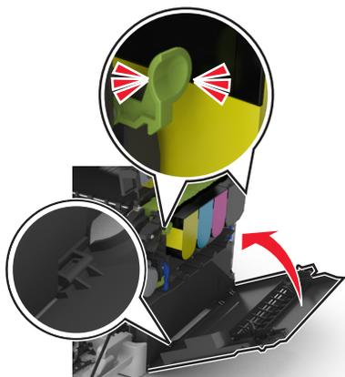
9 Deslize e segure a trava de liberação da na lateral direita da impressora e, devagar, feche a porta superior.
