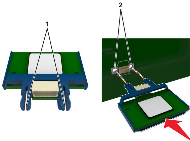
4 Pressione a placa com firmeza no lugar conforme mostrado na ilustração.
