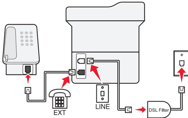
Линия DSL разделяет обычную телефонную линию на два канала: голосовой и Интернет. Сигналы телефона и факса передаются по голосовому каналу, а сигналы Интернета – по другому. Таким образом одну линию можно использовать для аналоговых голосовых вызовов (включая факсы) и для цифрового доступа в Интернет.
