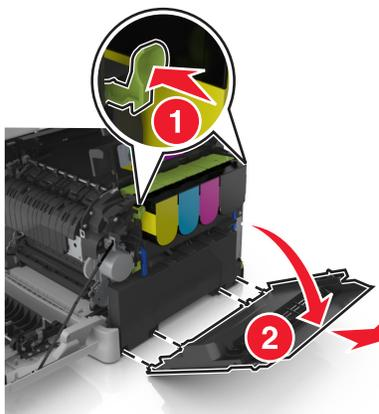
5 Нажмите на зеленые рычаги с обеих сторон емкости для отработанного тонера и извлеките ее.
