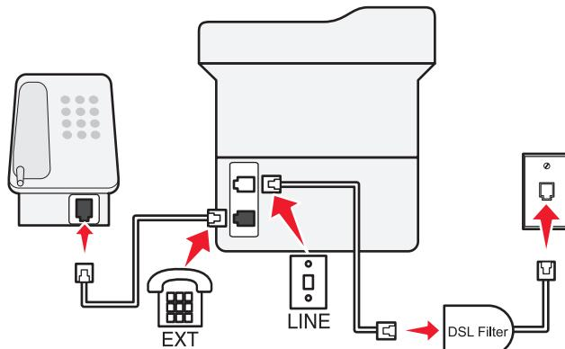
“数字用户线”将您的常规电话线路分为两个通道：语音和 Internet。电话和传真信号通过语音通道传输，而 Internet 信号通过另一个通道传输。这样，您可以使用同一条线路进行模拟语音呼叫（包括传真）和数字 Internet 访问。
