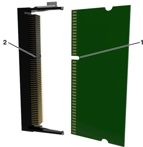
4 将内存卡笔直推入连接器中，然后将卡朝着控制器板墙推，直到它发出“喀”一声，卡入到位。
