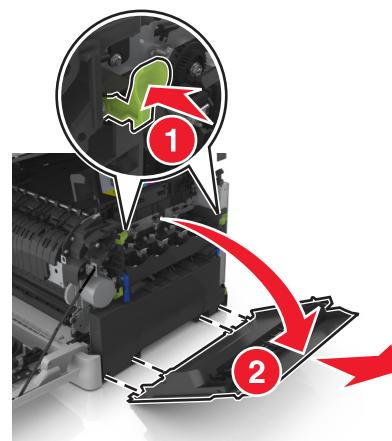
5 按废碳粉瓶两边的绿色控制杆，然后移除废碳粉瓶。
