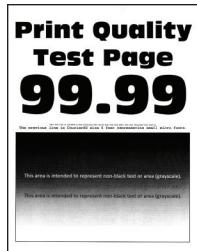
**Poznámka:** Před odstraňováním problému vytiskněte zkusební stránku. Na ovládacím panelu přejděte do nabídky **Nastavení > Řešení problémů > Tisk zkusební stránky**. U modelů bez dotykové obrazovky procházejte nastavením pomocí tlačítka **OK**.
