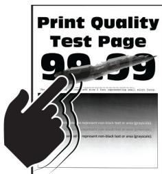
**Poznámka:** Před odstraňováním problému vytiskněte zkušební stránku. Na ovládacím panelu přejděte do nabídky **Nastavení > Řešení problémů > Tisk zkušební stránky**. U modelů bez dotykové obrazovky
