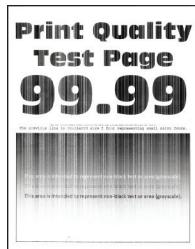
**Poznámka:** Před odstraňováním problému vytiskněte zkušební stránku. Na ovládacím panelu přejděte do nabídky **Nastavení > Řešení problémů > Tisk zkušební stránky**. U modelů bez dotykové obrazovky procházejte nastavením pomocí tlačítka **OK**.
