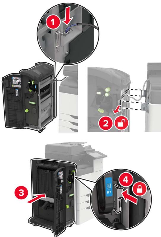
**9** Vložte kazetu se svorkami dovnitř tak, až zaklapne na místo.
