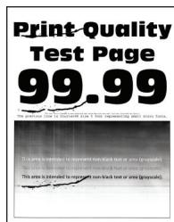
**Poznámka:** Před odstraňováním problému vytiskněte zkušební stránku. Na ovládacím panelu přejděte do nabídky **Nastavení > Řešení problémů > Vytisknout zkušební stránku**. U modelů bez dotykové obrazovky procházejte nastavením pomocí tlačítka **OK**.
