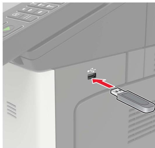
**3** Stiskněte tlačítko **Skenovat do USB** a v případě potřeby upravte nastavení.
