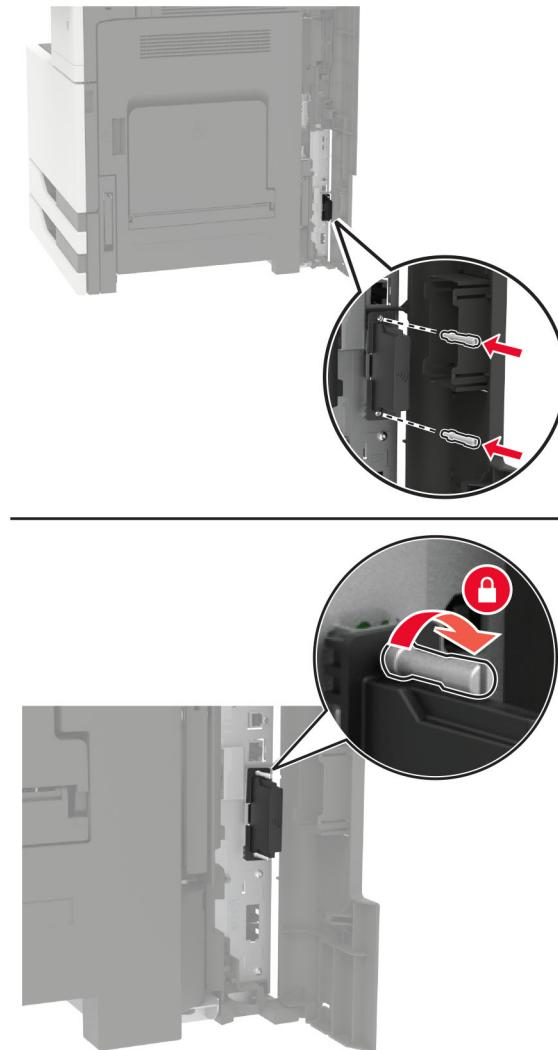
9 ワイヤレスプリントサーバーをコントローラボードに接続します。
