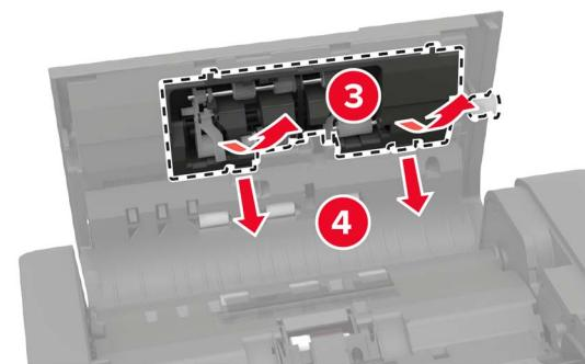
4 新しいピックローラーおよび給紙ローラーを取り出します。
