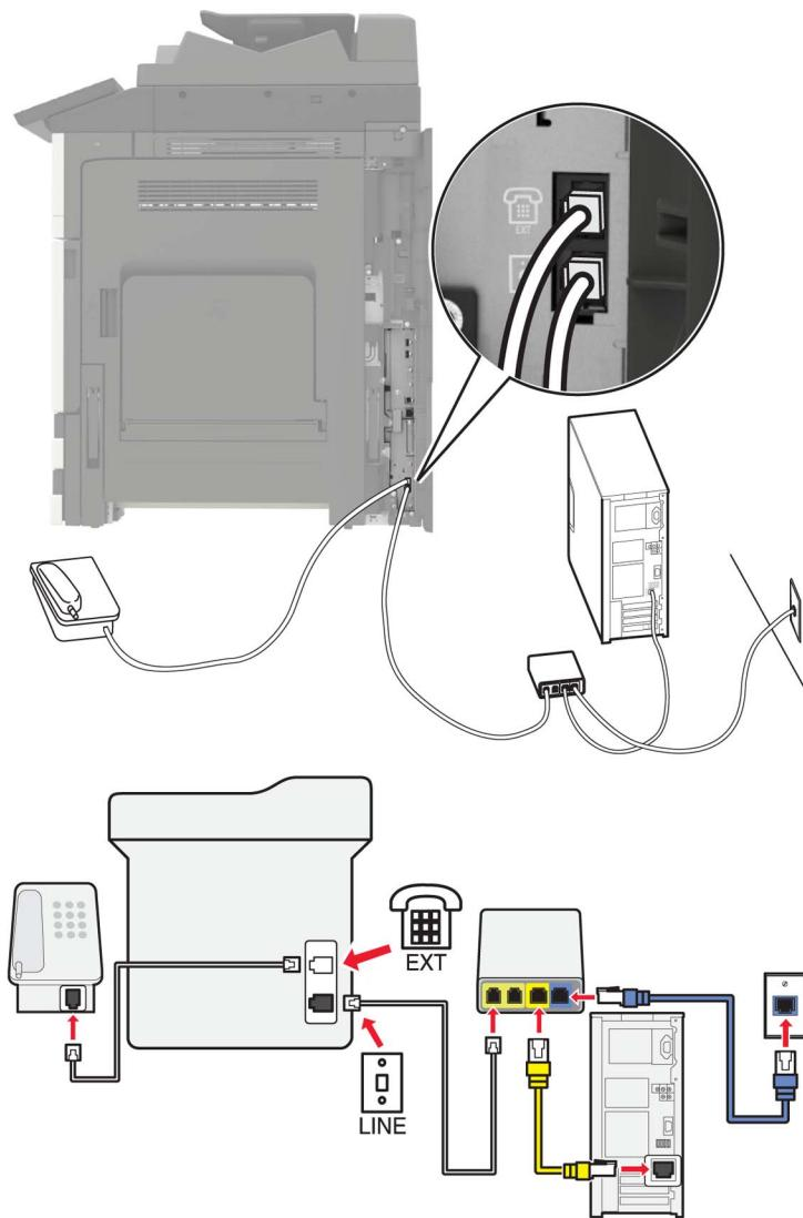
1 電話ケーブルの一方の端をプリンタの LINE ポートに接続します。
