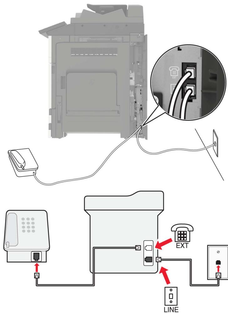
1 電話ケーブルの一方の端をプリンタの LINE ポートに接続します。
