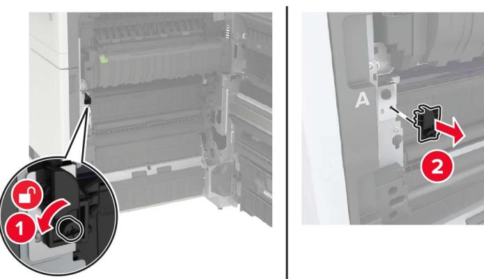
4 転写ベルトを固定しているネジを緩めます。
