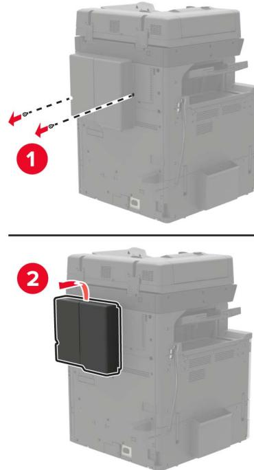
5 コントローラボードのアクセスカバーを取り外します。
