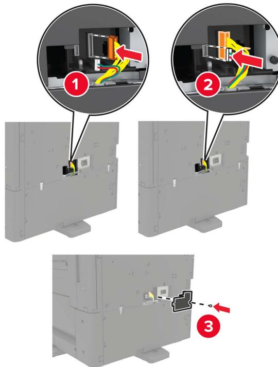
23 トレイ 2 および 3 を開き、ロッククリップと金属のブラケットで 2 x 500 枚または 2500 枚トレイをプリンタに固定します。
