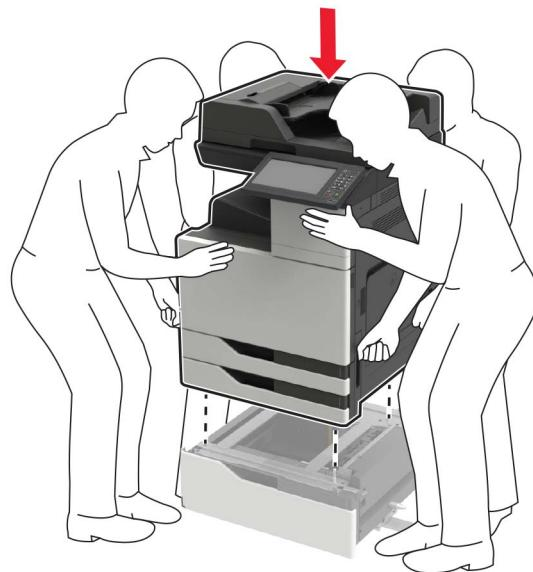
16 3000 枚トレイをプリンタに合わせ、取り付け支柱を取り付けます。
