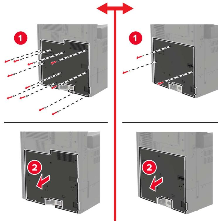
6 コントローラボードのシールドを取り外します。
