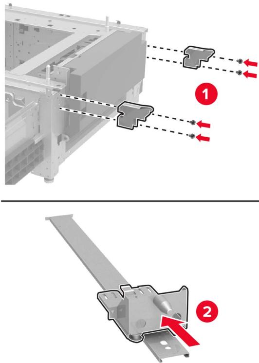
13 レールを取り付け、取り付けブラケットとレールカバーを取り付けます。
