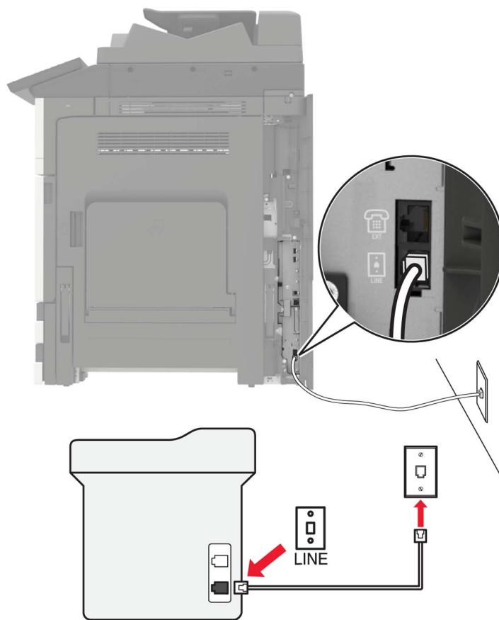
1 電話ケーブルの一方の端をプリンタの LINE ポートに接続します。
