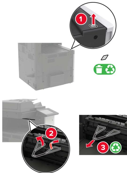
6 ドア A に入っているマイナスドライバを使用して、用紙ガイドセンサとスライドレールのカバーを取り外します。
