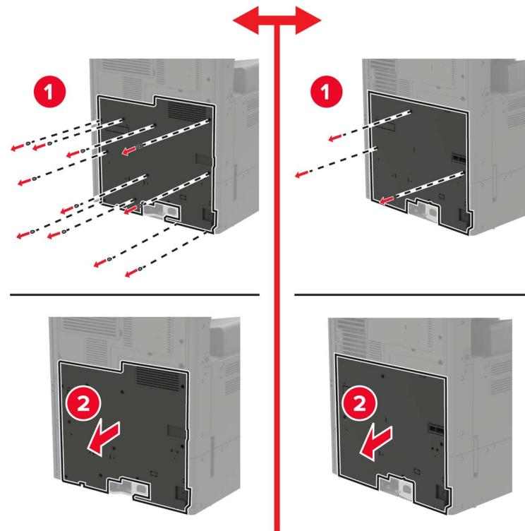
4 コントローラボードのシールドを取り外します。
