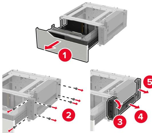
12 サイド取り付けブラケットをトレイに取り付け、ガイドプレートをレールに挿入します。
