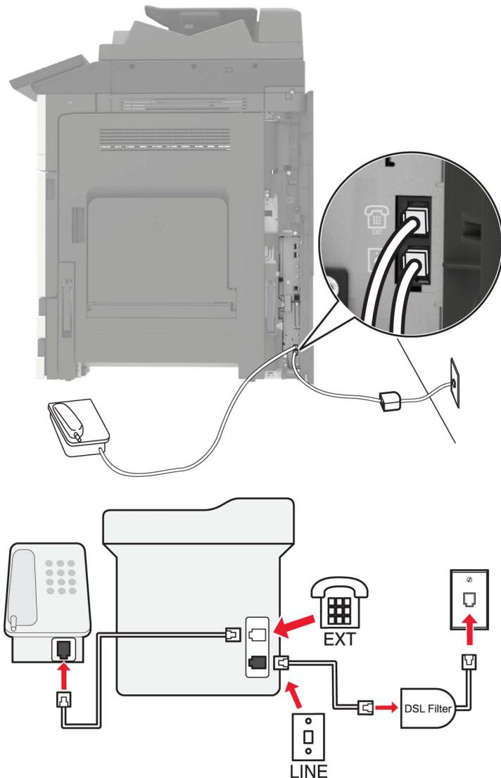
デジタル加入者回線(DSL)では、通常の電話回線が 2 つのチャネル、音声チャンネルとインターネットチャンネルに分けられます。電話と FAX の信号は音声チャネルで送受信され、インターネットの信号は別のチャネルで送受信されます。
