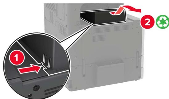
5 接着カバーを取り外し、用紙仕切りを取り外します。
