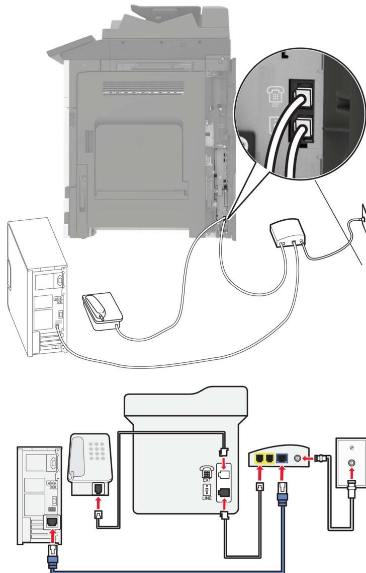
1 電話ケーブルの一方の端をプリンタの LINE ポートに接続します。
