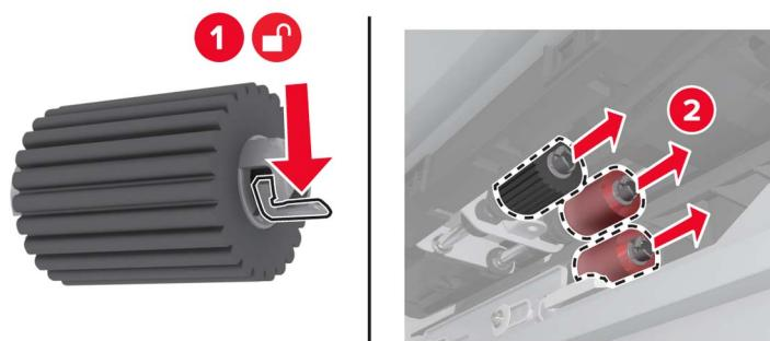
7 所定の場所でカチッと音がするまで、新しいローラーを挿入します。
