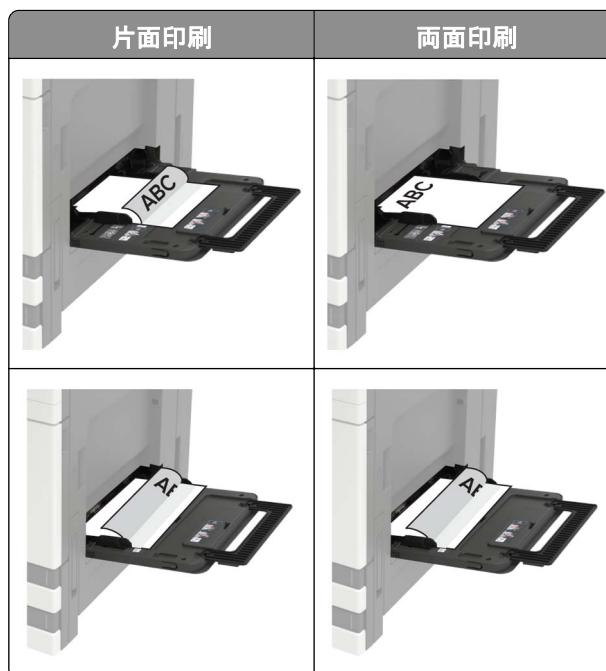
**警告—破損の恐れあり:** 封筒を使用する場合は、切手、留め金、スナップ、窓、つや出し加工された内張り、封かん用口糊の付いた封筒は使用しないでください。
