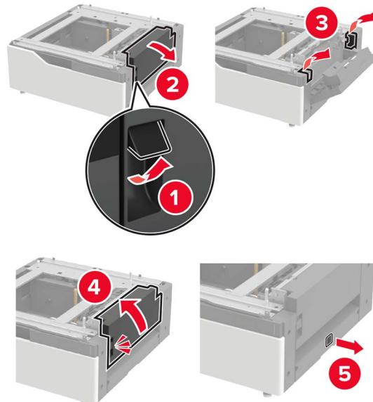
11 トレイを開き、取り付けブラケットとレールカバーを取り外します。
