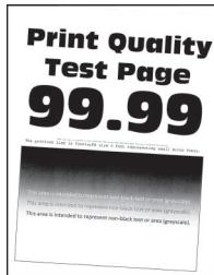
**Notă:** Înainte de soluționarea problemei, imprimăți paginile de testare a calității imprimării. Din panoul de control, accesăți **Setări > Depanare > Pagini de testare a calității imprimării**. Pentru modelele de imprimantă care nu dispun de ecran tactil, apăsați **OK** pentru a naviga printre setări.
