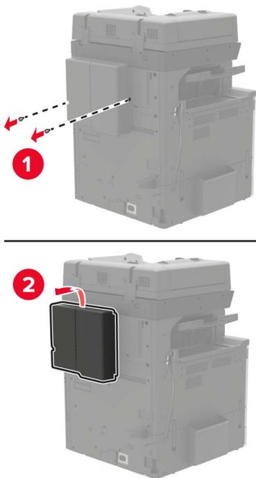
5 Снимите защитную крышку системной платы.
