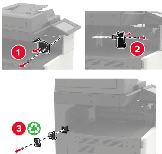
**7** Снимите направляющие бумаги.
