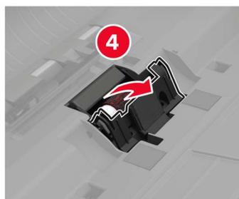
3 Снимите ролик разделения УАПД.
