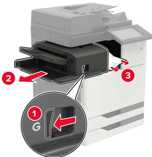
При необходимости проверните колесико G1 вниз, чтобы подать замятую бумагу в выходной лоток брошюровщика, затем уберите замятую бумагу.
