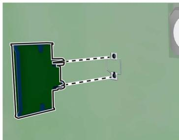
**Примечание:** Разъем платы микропрограммного обеспечения должен соприкоснуться с системной платой по всей длине и располагаться в одной плоскости с ней.
