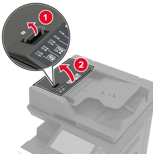
3 Снимите ролики захвата и подачи УАПД.
