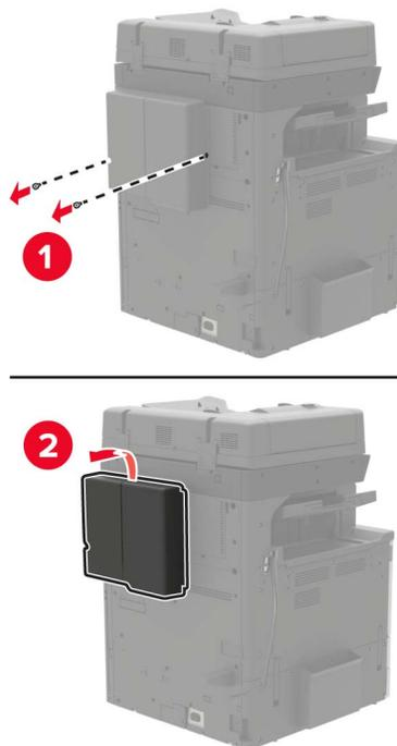
5 Снимите защитную крышку системной платы.
