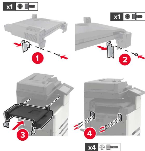
8 将完成器连接到打印机上。
