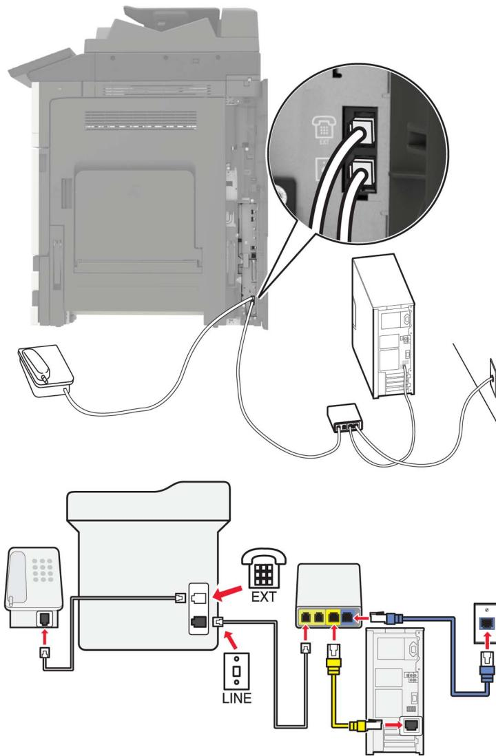
**1** 将电话线的一端连接到打印机的线路端口。
