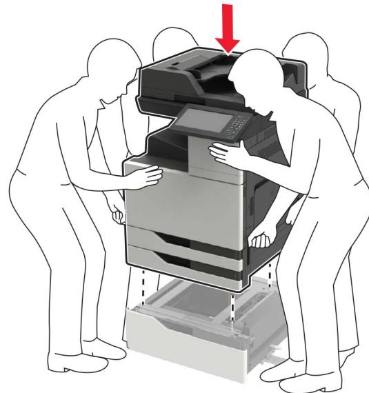
**16** 将 3000 页进纸匣与打印机对齐，然后安装固定柱。
