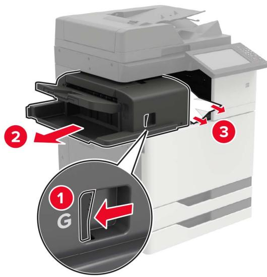
如果需要，向下转动转轮 G1 以将被卡的纸张送入完成器接纸架中，然后取出被卡的纸张。
