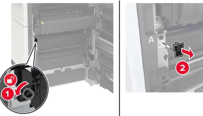
4 松开固定转印带的螺钉。
