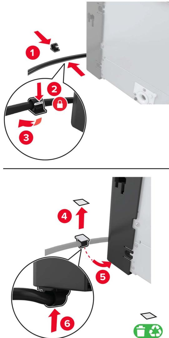
**18** 将进纸匣电缆连接到打印机上。
