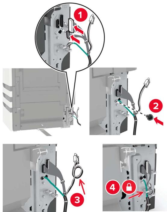
**19** 安装进纸匣电缆盖板。
