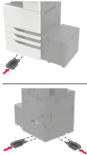
22 将 2 x 500 或 2500 页进纸匣连接器连接到打印机上。
