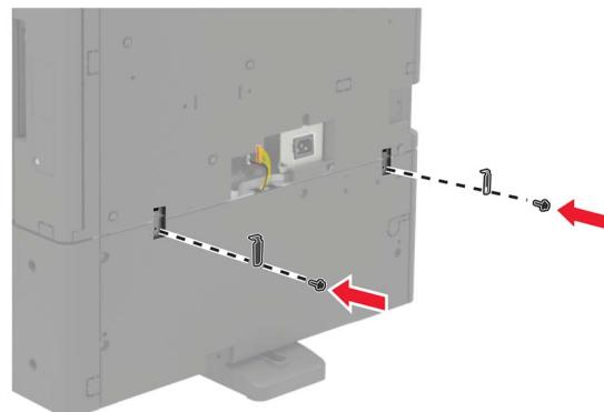
10 关闭进纸匣，然后安装连接器盖板。
