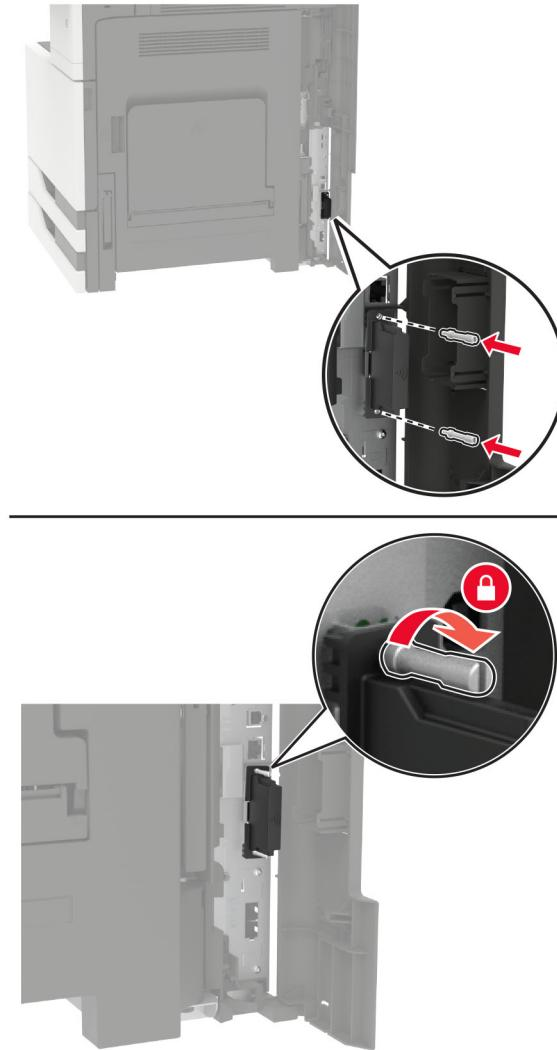
**9** 将无线打印服务器连接到控制器板上。
