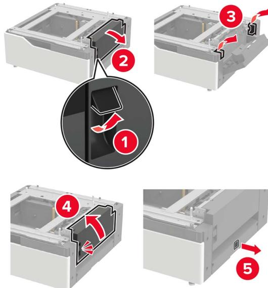
**11** 打开进纸匣，然后移除安装支架和导轨盖板。
