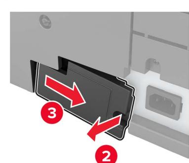
4 如果打印机有过滤器盖板，请移除盖板。
