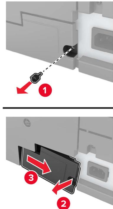
4 如果打印机有过滤器盖板，请移除盖板。
