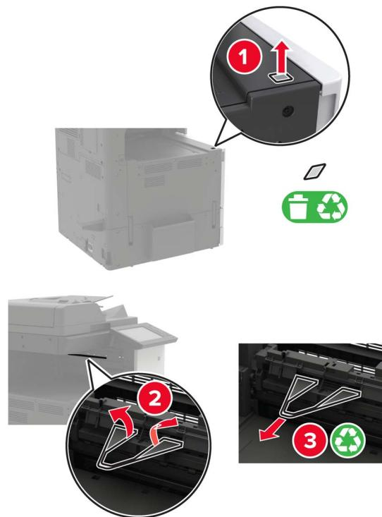
6 使用存储在盖门 A 内部的螺丝起子移除纸张导片传感器和滑轨的盖板。
