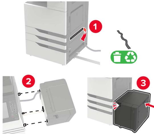
**21** 将稳定脚安装到打印机上。
