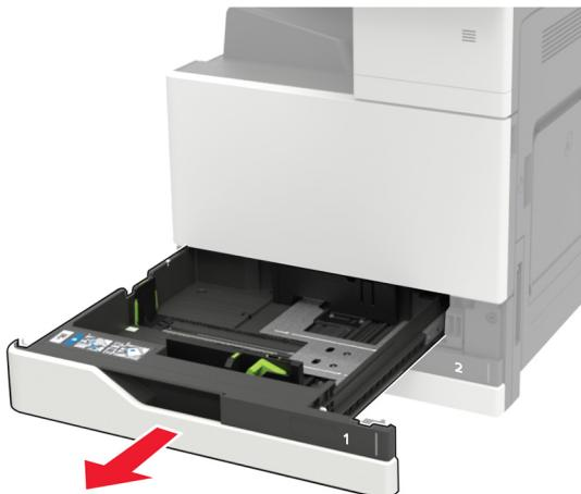
**2** 調整導引夾，以符合您所載入的紙張尺寸。
