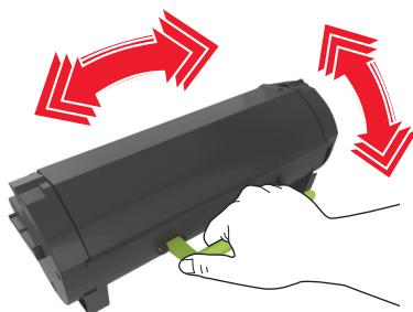
5 将碳粉盒的侧导轨与打印机内部侧导轨上的箭头对齐，然后将碳粉盒插入打印机中。
