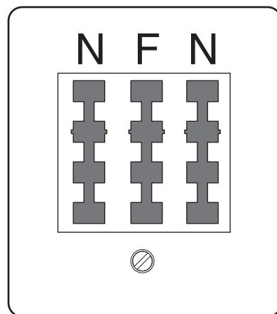
将打印机连接到任意 N 端口。
