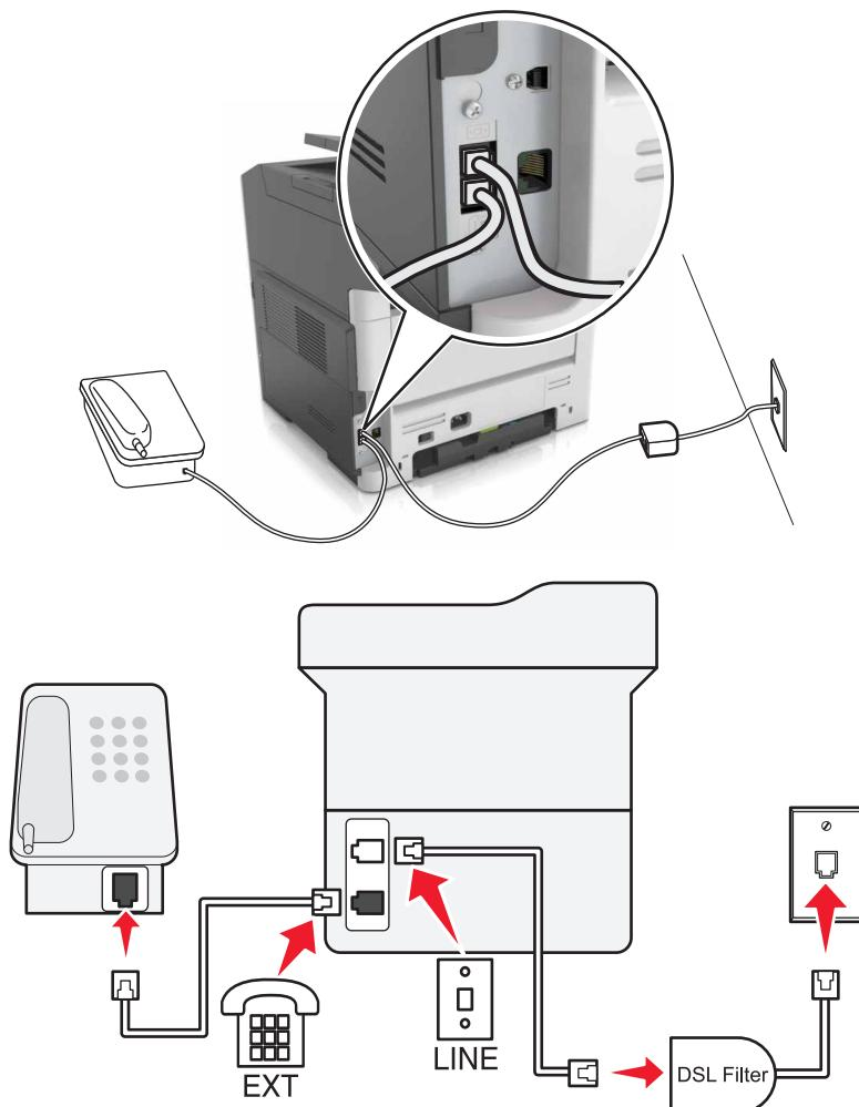
“数字用户线”将您的常规电话线路分为两个通道：语音和 Internet。电话和传真信号通过语音通道传输，而 Internet 信号通过另一个通道传输。这样，您可以使用同一条线路进行模拟语音呼叫（包括传真）和数字 Internet 访问。
