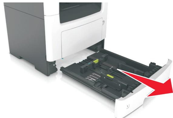
**2** 压住宽度导片凸柱，然后将它滑动到与您加载的纸张尺寸相符的正确位置上。
