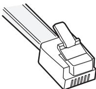
En adapterplugg kan være installert i skriverens ☎-port. Hvis du bruker en telefonadapter eller et lokale som har et toports- eller seriekoblingssystem, må du ikke fjerne adapterpluggen fra skriverens ☎-port.
