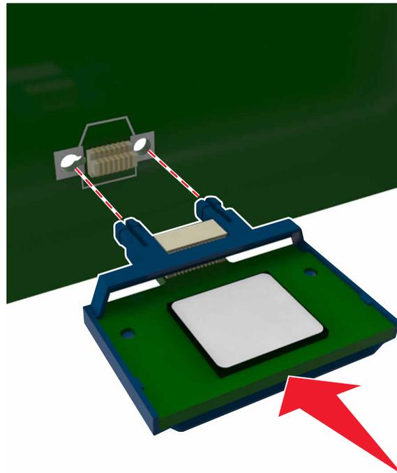
**Advarsel – mulig skade:** Hvis kortet ikke installeres på riktig måte, kan det føre til skade på kortet og kontrollerkortet.
