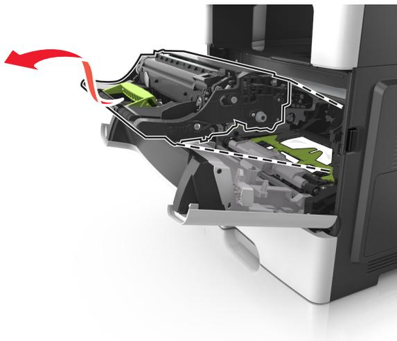
**Advarsel – mulig skade:** Ikke utsett bildeenheten for direkte lys i mer enn ti minutter. Lengre eksponering for lys kan føre til problemer med utskriftskvaliteten.
