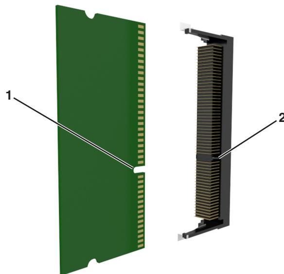
**4** 将内存卡笔直推入连接器中，然后将卡朝着控制器板墙推，直到它发出“喀”一声，卡入到位。
