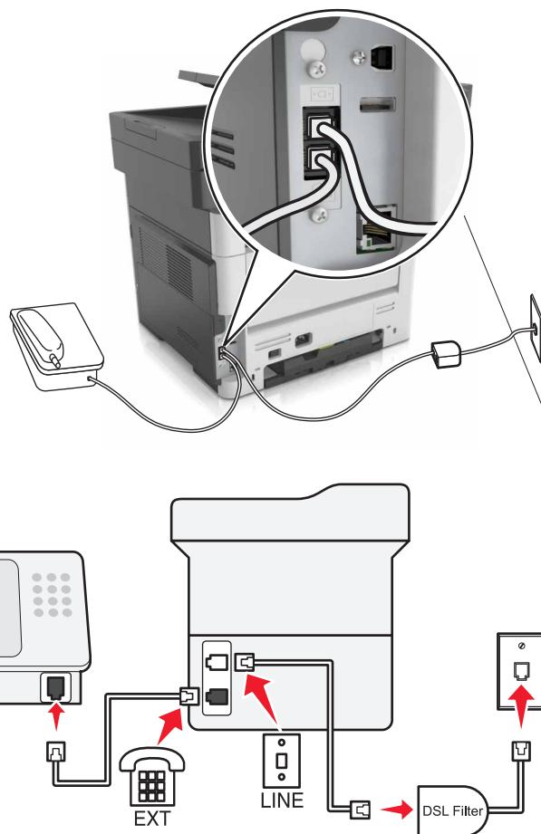
“数字用户线”将您的常规电话线路分为两个通道：语音和 Internet。电话和传真信号通过语音通道传输，而 Internet 信号通过另一个通道传输。这样，您可以使用同一条线路进行模拟语音呼叫（包括传真）和数字 Internet 访问。
