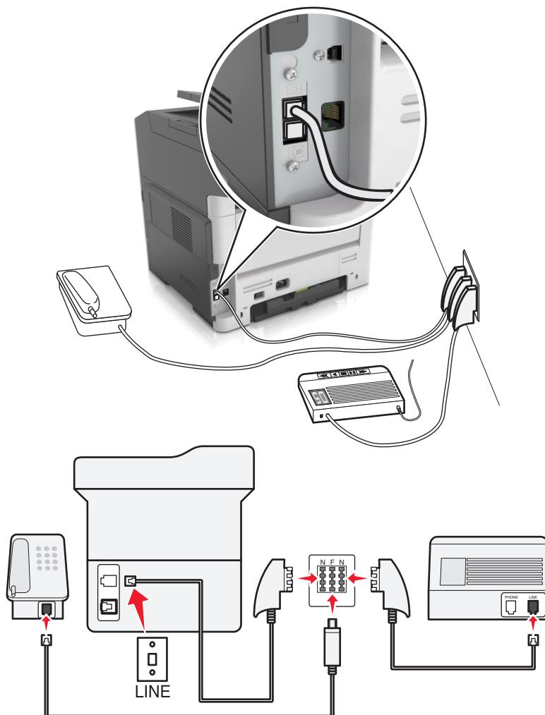
1 将随打印机附带的电话线的一端连接到打印机的 端口。
