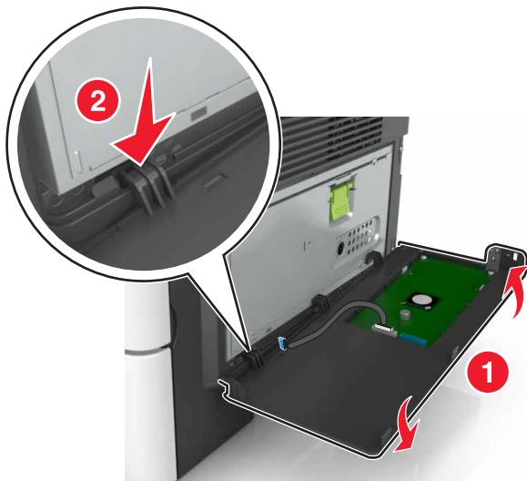
**10** Senk resten av dekselet og skyv deretter dekselet til høyre.
