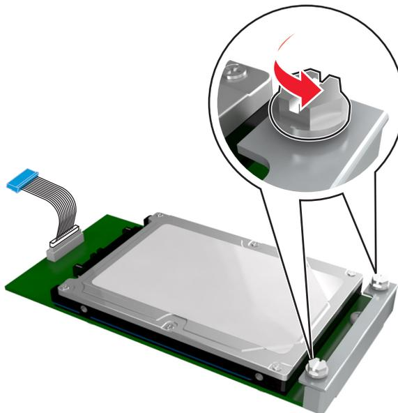
**b** Insérez la fiche du câble d'interface du disque dur de l'imprimante dans la prise de la carte contrôleur.
