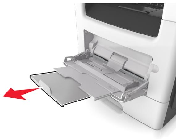
2 握住左寬度導引夾上的定位拉片，然後針對您載入的紙張來移動導引夾。
