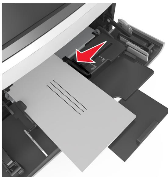
**Advertencia: Posibles daños:** No utilice nunca sobres con sellos, cierres, broches, ventanas, revestimientos oleosos o autoadhesivos. Este tipo de sobres puede dañar seriamente la impresora.
