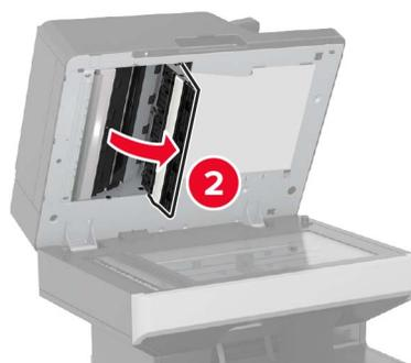
**5** Limpie el cristal del escáner del ADF debajo de la cubierta del ADF.
