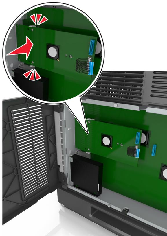
**8** Utilice el tornillo de ajuste manual proporcionado para acoplar el soporte de plástico al ISP.
