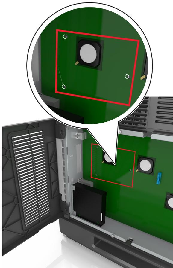
**Nota:** Si hay instalado un ISP opcional, el disco duro de la impresora debe instalarse en él.
