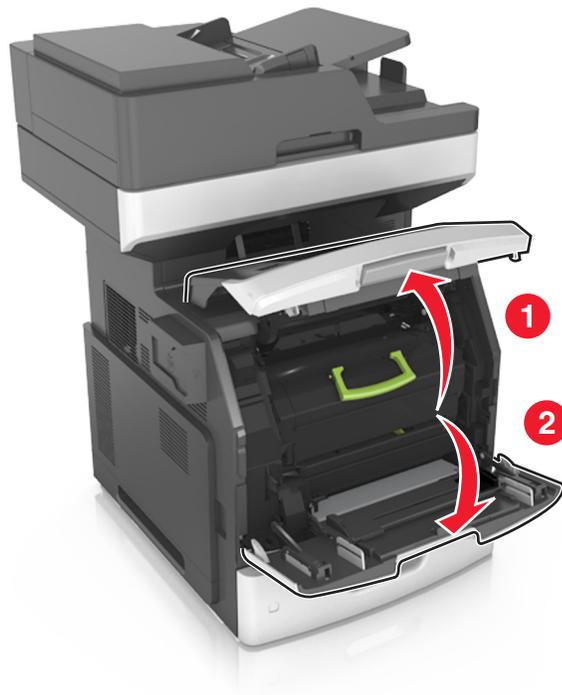
**2** Extraiga el cartucho de t ner de la impresora, mediante la palanca.
