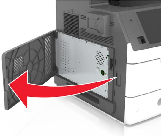
**2** Con un destornillador, afloje los tornillos del protector de la placa del controlador.
