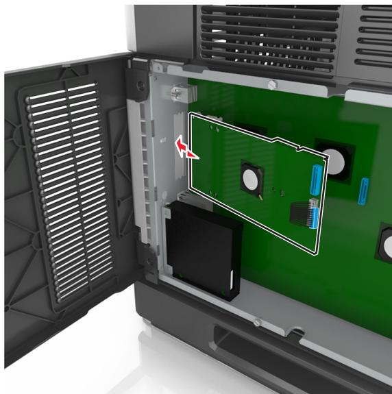
**Nota:** Coloque el ISP en ángulo sobre el soporte de plástico para que cualquier conector que sobresalga pase por la abertura del ISP en la carcasa de la placa.
