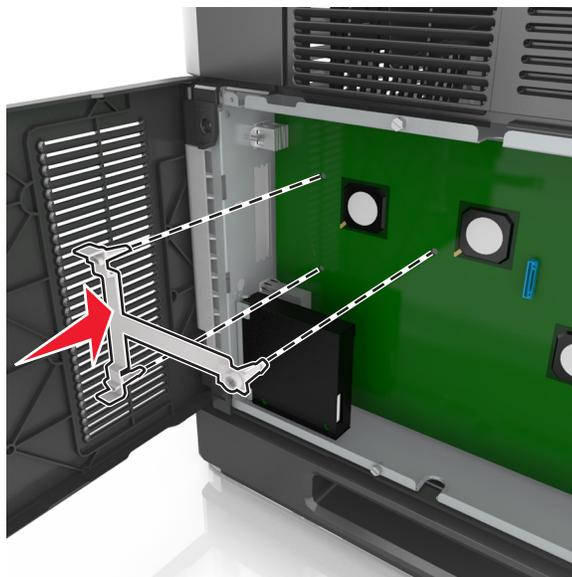
**Nota:** Asegúrese de que el soporte de plástico esté bien encajado y de que esté colocado firmemente en la carcasa de la placa.
