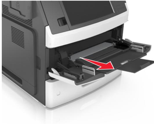
**Nota:** Mueva con cuidado la parte extensible para que el alimentador multiuso quede completamente extendido y abierto.
