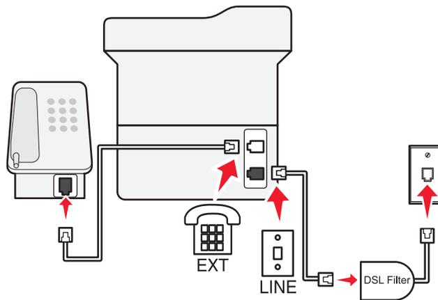
Una línea digital de abonado (DSL) divide la línea de teléfono habitual en dos canales: voz e Internet. Las señales de teléfono y fax viajan a través del canal de voz mientras que la señal de Internet transcurre por el otro canal. Instale un filtro DSL para minimizar las interferencias entre los dos canales y garantizar una conexión de calidad.
