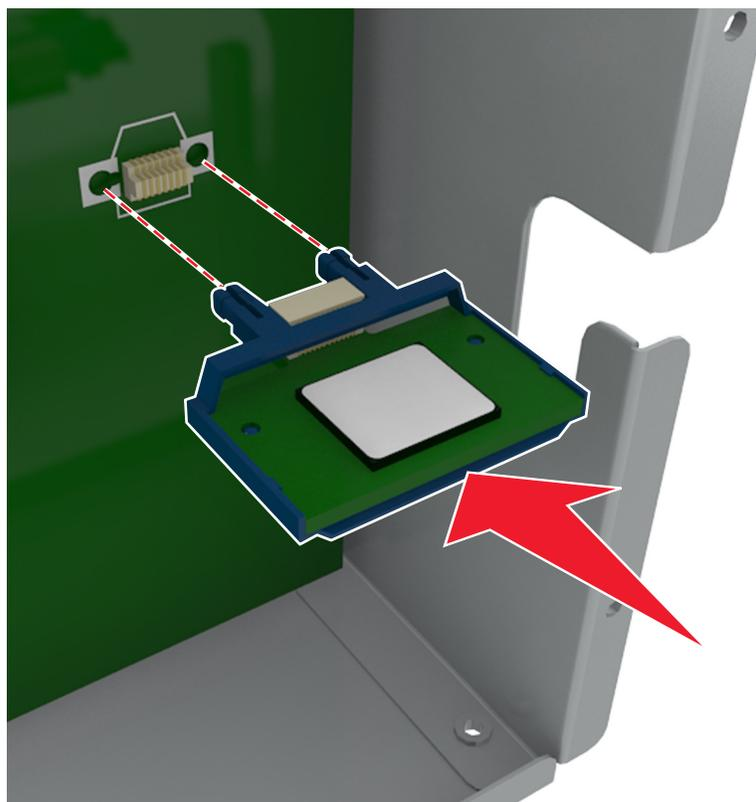
**Attenzione - Possibili danni:** L'installazione errata della scheda può danneggiare la scheda stessa e il controller.
