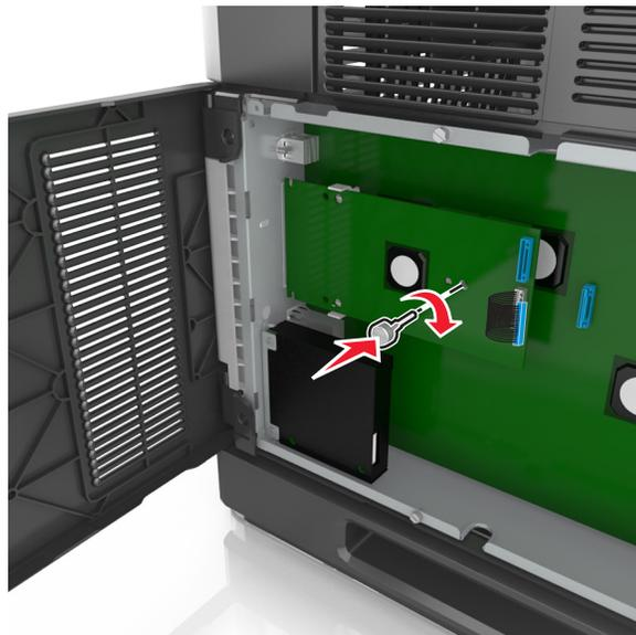
**Nota:** Ruotare la vite in senso orario in modo da tenere l'ISP in posizione, ma non serrare ancora la vite.
