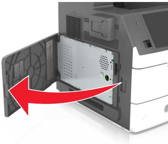
**2** Utilizzando un cacciavite, allentare le viti sulla schermatura della scheda del controller.
