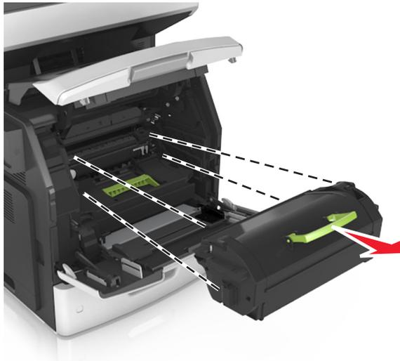
3 新しいトナーカートリッジを開梱し、梱包材を取り除き、カートリッジを振ってトナーを再度分散させます。
