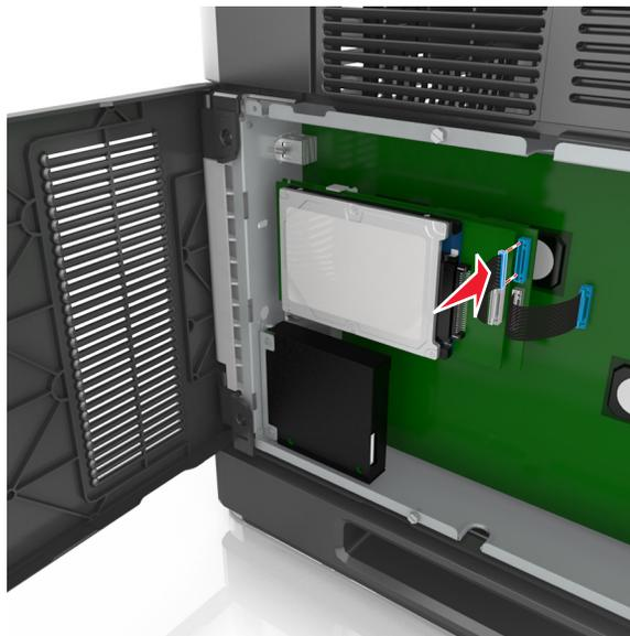
プリンタハードディスクをコントローラボードケースに取り付けるには、次の手順に従います。
