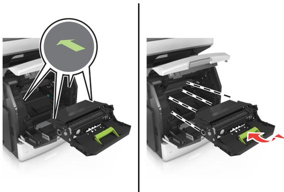
7 カートリッジの側面のレールをプリンタ内部の側面のレールにある矢印に合わせ、トナーカートリッジをプリンタに挿入します。
