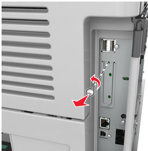
b 金属のカバーを持ち上げ、完全に引き出します。
