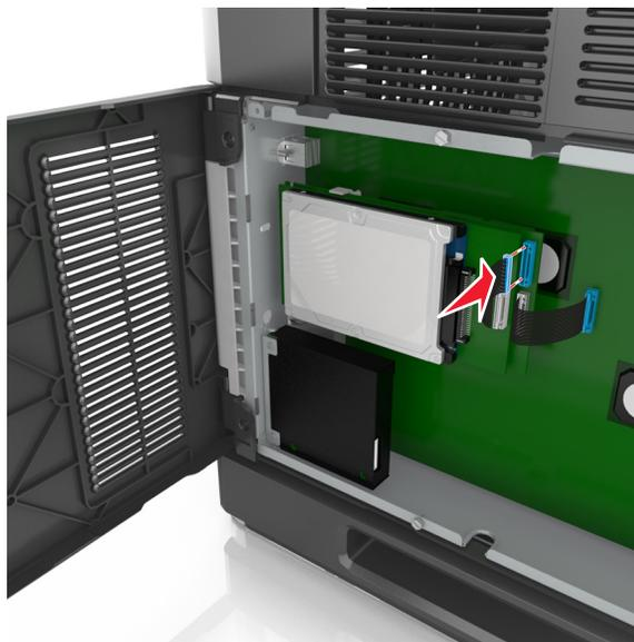
Slik installerer du en skriverharddisk direkte på kontrollerkortholderen:
