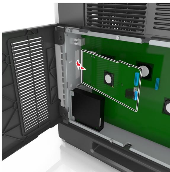
**Merk:** Hold ILP-en skrått over plastbraketten, slik at eventuelle overhengende tilkoblinger vil gå gjennom ILP-åpningen i holderen.
