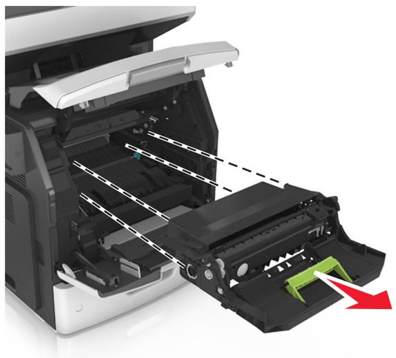
**Advarsel – mulig skade:** Ikke utsett bildeenheten for direkte lys i mer enn ti minutter. Lengre eksponering for lys kan føre til problemer med utskriftskvaliteten.
