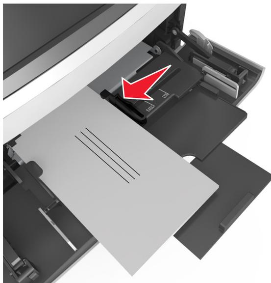
**Advarsel – mulig skade:** Bruk aldri konvolutter med frimerker, klips, klemmer, vinduer, foring eller selvklebende lim. Slike konvolutter kan forårsake alvorlig skade på skriveren.
