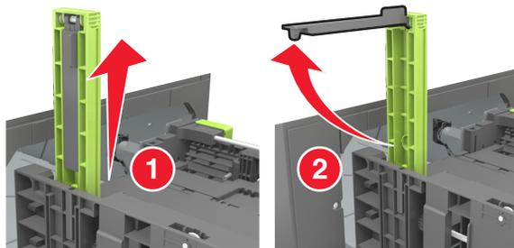
**г** Установите направляющую длины для формата А5 в предназначенный для нее слот.
