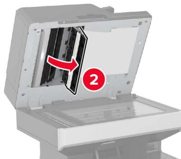
5 Протрите стекло сканера устройства автоматической подачи под дверцей УАП.
