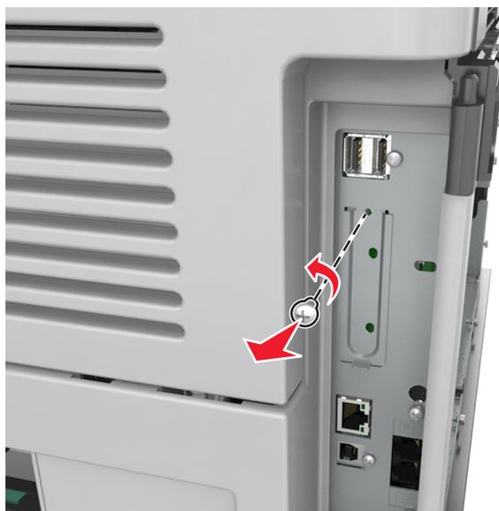
**б** Поднимите металлическую крышку, затем вытяните ее полностью.
