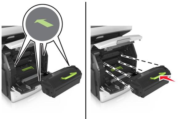
7 Закройте дверцу многоцелевого устройства подачи и переднюю крышку.
