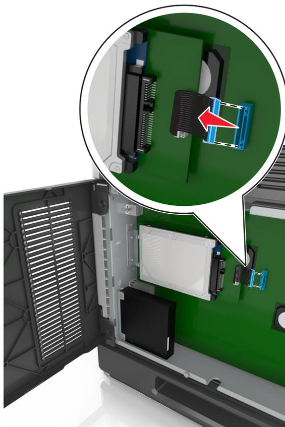
**3** Удалите винты, с помощью которых крепится жесткий диск принтера.
