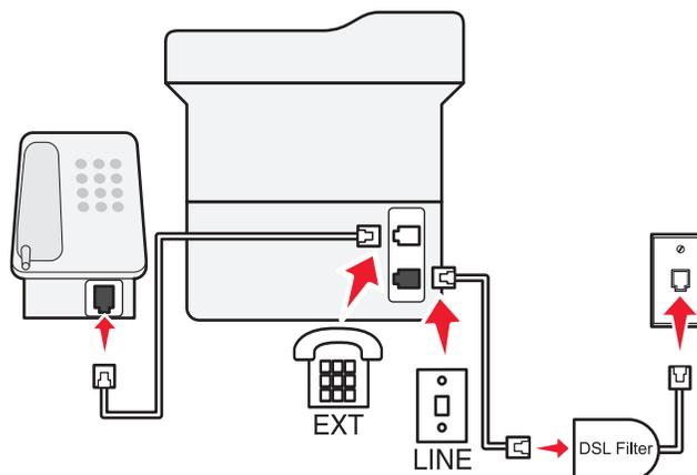
Линия DSL разделяет обычную телефонную линию на два канала: голосовой и Интернет. Сигнал телефона и факса передаются по голосовому каналу, а сигнал Интернета – по другому.
