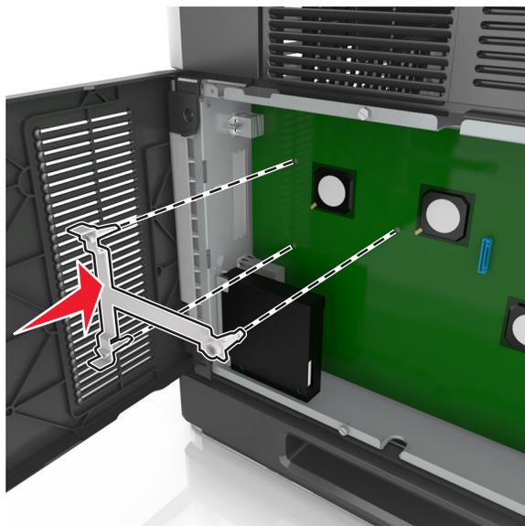
**Примечание:** Убедитесь, что пластиковый кронштейн полностью закреплен, и что пластиковый кронштейн надежно установлен на каркасе.
