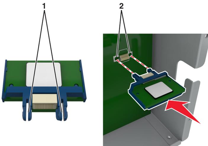
4 С усилием вставьте плату в разъем, отображенный на иллюстрации.
