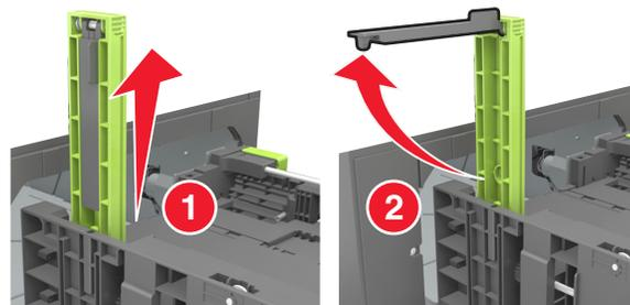
**d** 将 A5 长度导片插入其指定的插槽中。
