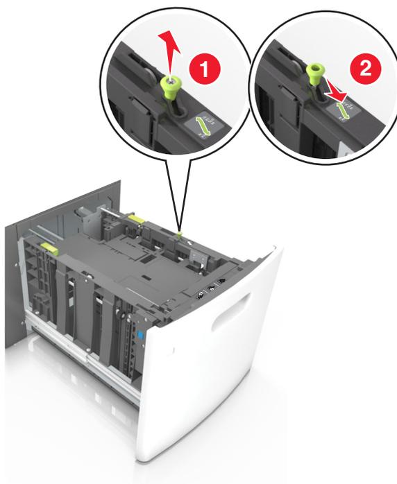
**b** 压住长度导片并将它滑动到 A5 的位置，直到它发出咔嚓一声，卡入到位。
