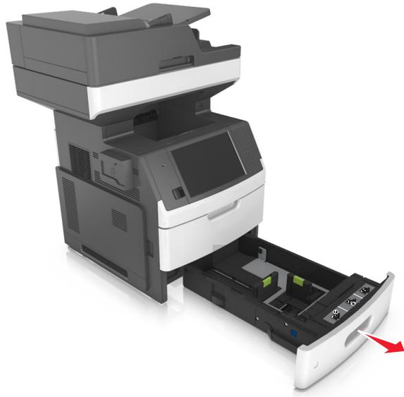
2 压住宽度导片，并将它滑动到与您加载的纸张尺寸相符的正确位置上，直到它发出咔嚓一声，卡入到位。
