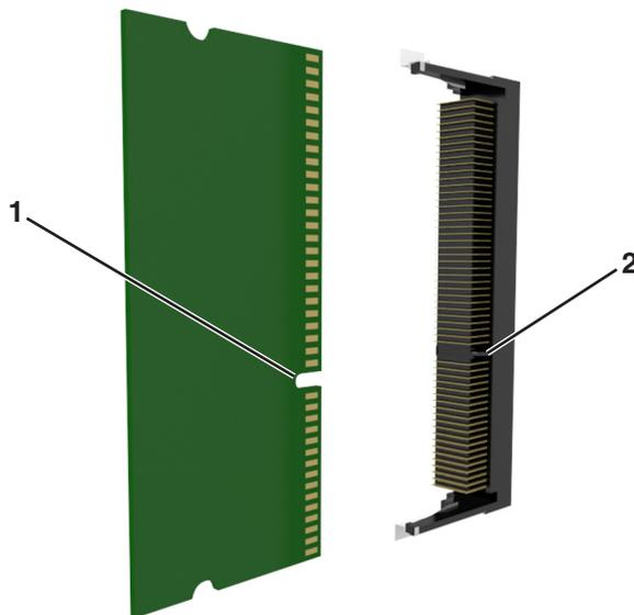
4 将内存卡笔直推入连接器中，然后将卡朝着控制器板墙推，直到它发出 *咔嗒* 一声，卡入到位。
