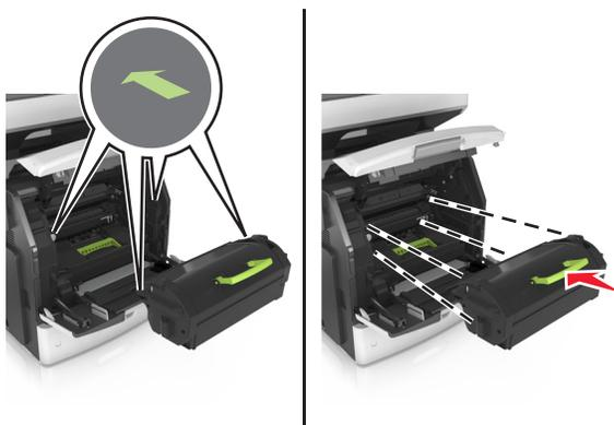
**警告—可能的损坏：**当更换碳粉盒时，不要让成像部件长时间暴露在直接的光线下。长时间暴露在光线下可能导致打印质量问题。
