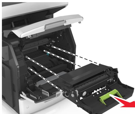
**請當心—潛藏損壞危險性：**成像組件直接曝露在光線下的時間不宜超過 10 分鐘。曝露在光線下太久，會導致列印品質發生問題。
