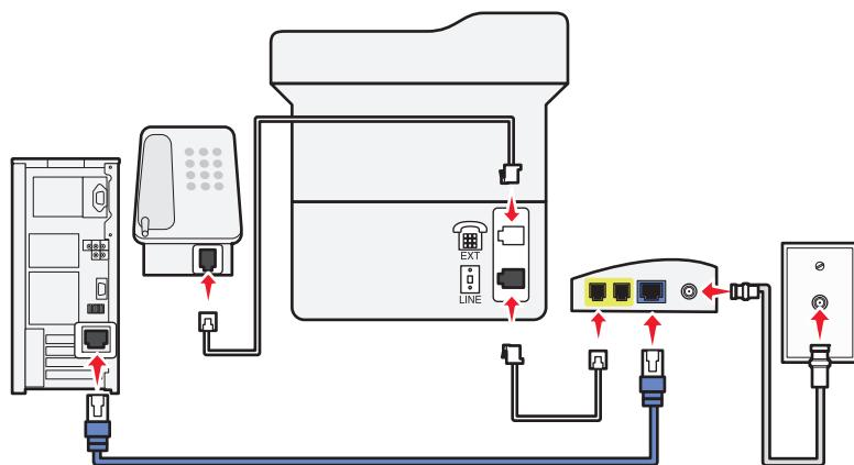
1 將電話線的一端連接到印表機的線路連接埠。
