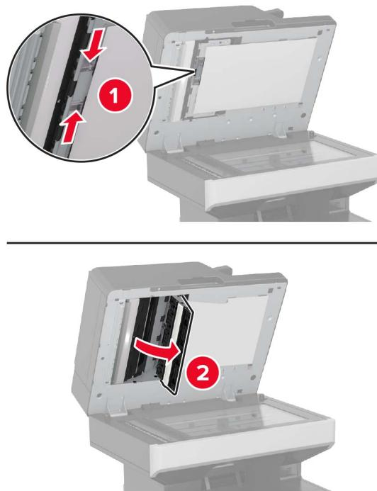
5 擦拭自動送件器門蓋下方的自動送件器掃描器玻璃面板。
