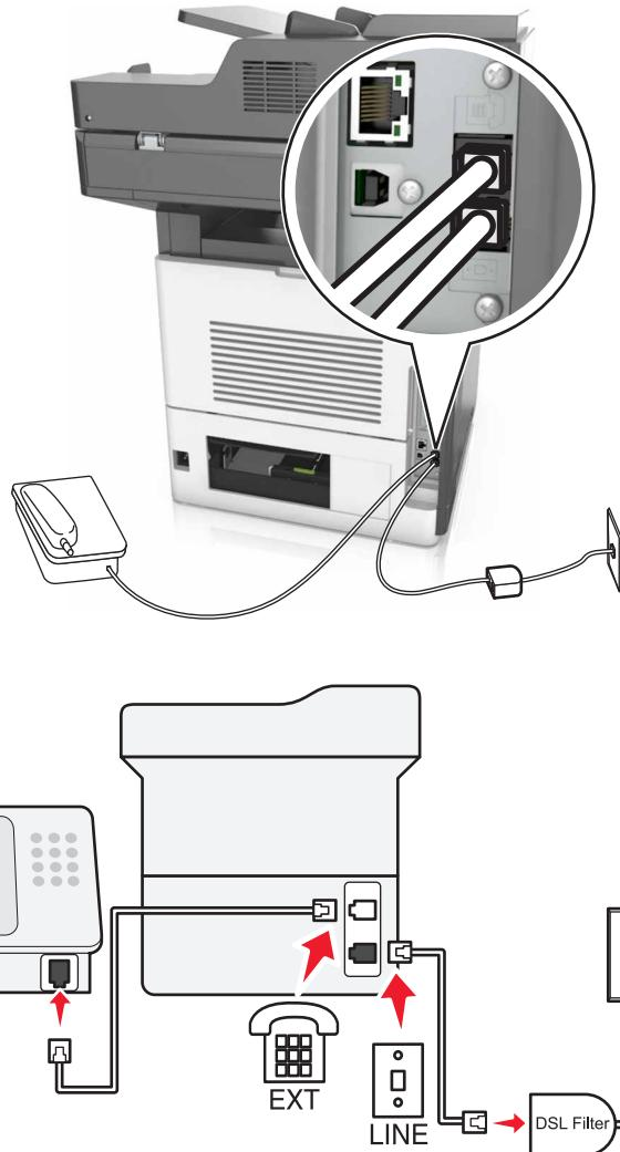
數位用戶線路 (DSL) 可將普通電話線路分成兩個頻道：語音和網際網路。電話和傳真信號透過語音頻道傳輸，網際網路信號則藉由另一個頻道傳輸。
