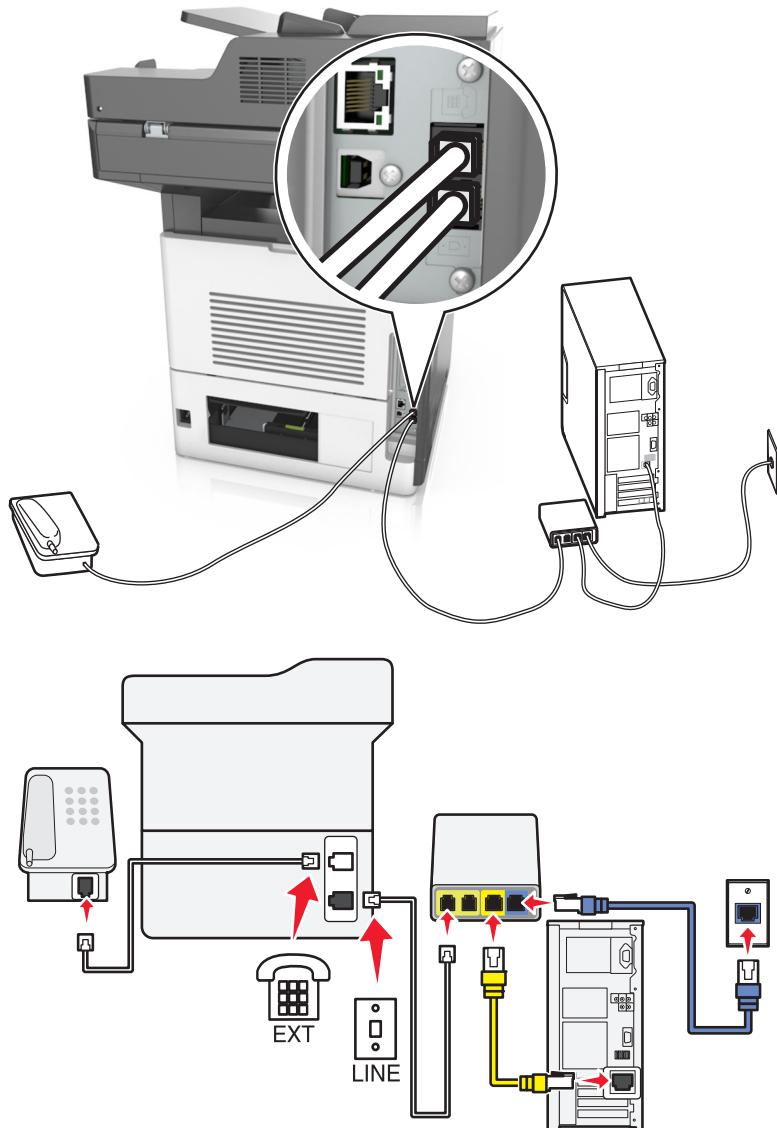
1 將電話線的一端連接到印表機的線路連接埠。
