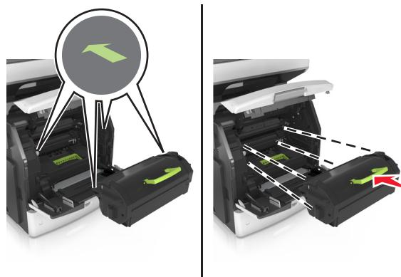
**請當心一潛藏損壞危險性：**更換碳粉匣時，請不要讓成像組件曝露於直接照射的光線過久的時間。曝露在光線下太久，會導致列印品質發生問題。
