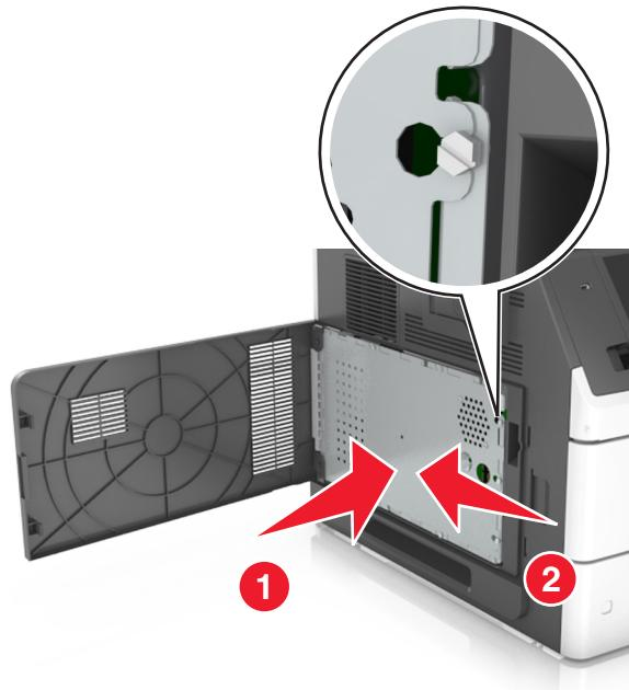
6 將防護蓋上的螺絲鎖緊。
