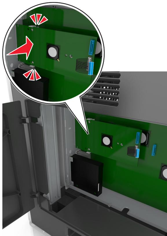
**8** Utilizzare la vite fornita per fissare la staffa in plastica all'ISP.
