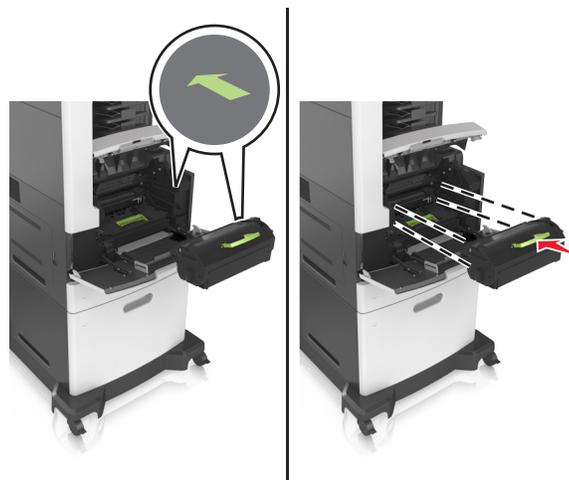
**Attenzione - Possibili danni:** Quando si sostituisce una cartuccia di toner evitare di esporre l'unità immagini alla luce diretta per un periodo di tempo prolungato. L'eccessiva esposizione alla luce può compromettere la qualità di stampa.
