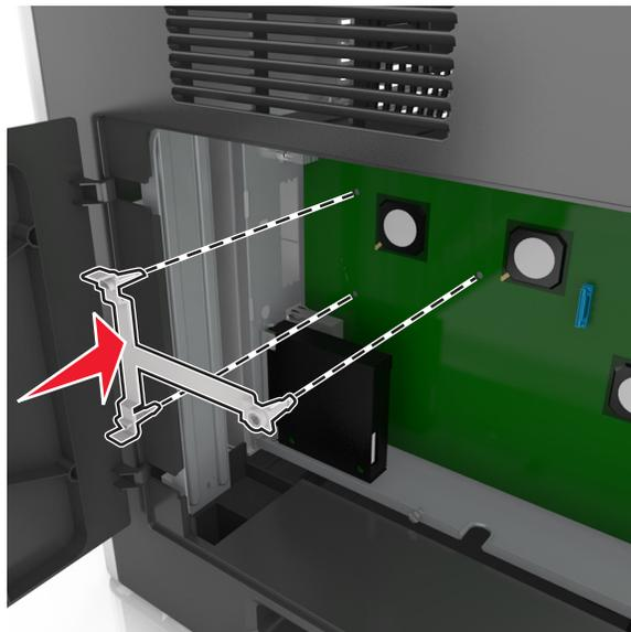
**Nota:** verificare che la staffa in plastica sia agganciata completamente e che sia saldamente inserita nell'alloggiamento.
