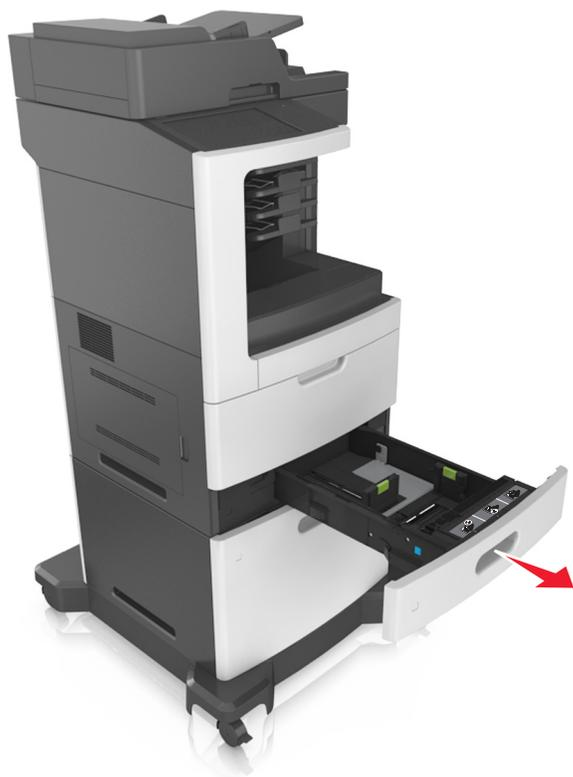
**2** 握住寬度導引夾，然後將它滑到符合所載入紙張尺寸的正確位置，直到它發出喀嚓一聲，卡入定位。
