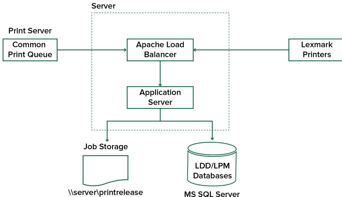
LDD プリントリリースワークフローを以下に示します。
