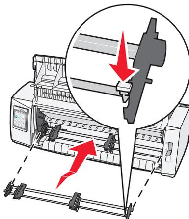
**7** Lassen Sie die Feststellhebel los.
