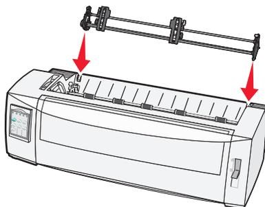
**8** So schieben Sie die Traktorzuführung in den Drucker:
