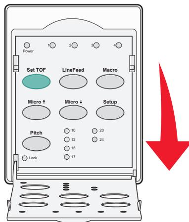
**6** Drücken Sie eine beliebige Papierbewegungstaste (**Zeilenvor.**, **Mikro↑**, **Mikro↓**), um die horizontalen Linien auf der Druckschiene mit dem gewünschten Seitenanfang auszurichten.
