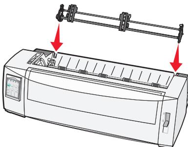
**8** Para deslizar o alimentador do tracionador para dentro da impressora:
