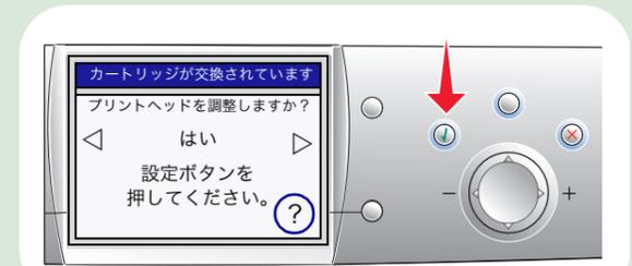
プリントヘッド調整パターンを印刷すると、プリントヘッドは自動的に調整されます。
