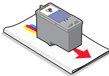
4 利用這塊布的其他乾淨區域，輕輕將清潔用布貼在接點上約三秒鐘，然後依顯示的方向擦拭。
