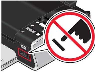
**請注意：**印表機一次只能辨識一個作用中的媒體裝置。如果您插入了一個以上的媒體裝置，顯示幕上會出現一則訊息，提示您指定您希望印表機加以辨識的裝置。
