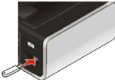
**Hinweis:** Hierfür ist u. U. ein Adapter erforderlich, falls das Flash-Laufwerk nicht direkt in den Anschluss passt.
