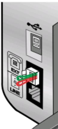
**Примечание.** Не удаляйте эту вставку. В случае ее удаления все другие телекоммуникационные устройства, установленные дома (например, телефоны или автоответчики), могут перестать работать.
